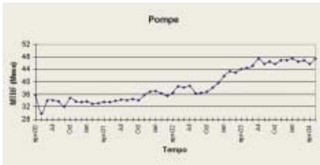
Fig. 2 Andamento MTBF pompe raffineria dal 2000 al 2004
