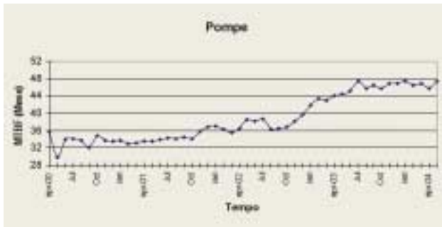
Fig. 2 Andamento MTBF pompe raffineria dal 2000 al 2004
